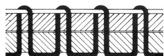
Fig. c: Tensão da linha da agulha muito forte ou tensão da linha do laçador muito fraca
