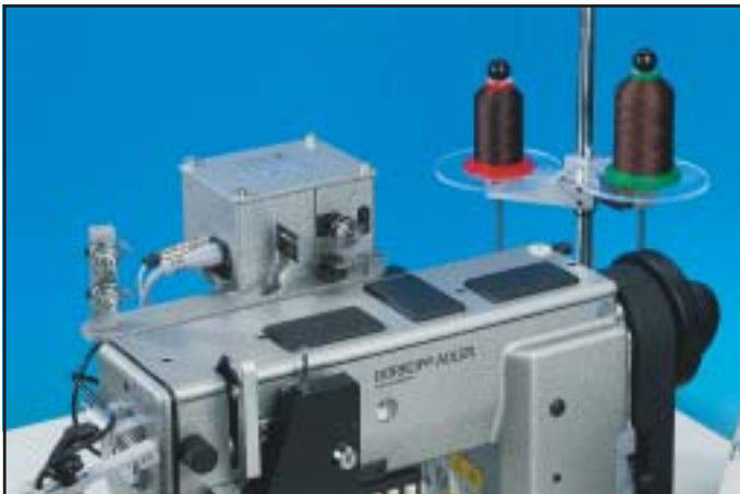
Prüfung und Dokumentation von Nähgarn und Spulvorgang Inspection and documentation of sewing thread and bobbin winding Contrôle et documentation du fil à coudre et du procédé d'enroulement
