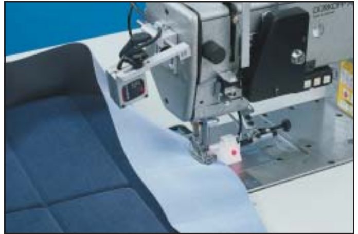
Sichere Erfassung des Sollreißnahtbereiches durch Glasfaseroptik Safe registration of the tearing seam section by glass fibre optics Reconnaissance sûre de la zone de couture à déchirure programmée grâce à l'éclairage à fibres optiques de verre
