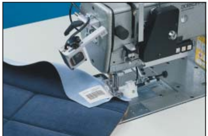
Scanner für Endlabel-Erfassung der I.O.-Teile Scanner for end label registration of the correctly sewn parts Scanner pour saisie des labels finals des pièces homologuées
