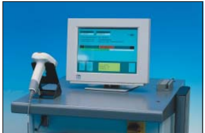
Industrie-PC / TFT-Monitor / Hands scanner / Kartenleser (zur Bedieneridentifikation) Industrial PC / TFT monitor / Hand scanner / Card scanner (for operator identification) Ordinateur industriel / écran TFT / scanner à main / lecteur de cartes (pour l'identification de l'opérateur)
