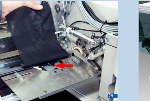
Formanschlag für Knopflochaschen • Bei Innentaschen mit Futterschlaufendreieck (90 Grad), nur in der Kombination mit einer Übergabevorrichtung. Der Knopflochaschen-Anschlag wird gegen den Auflage-tisch ausgetauscht.
