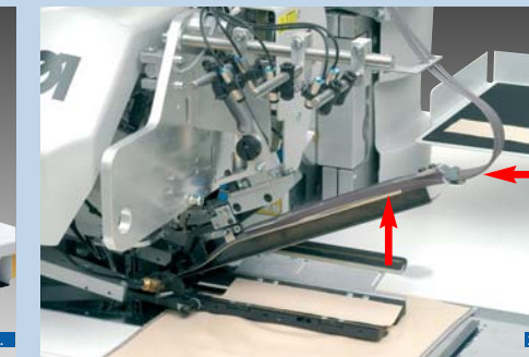
Reißverschlussführung für Endlos-Reißverschlüsse ohne Schloss • In Verbindung mit der Vorrichtung 0745 597544 und dem Fallstempel S100 (0793 026503). Bei dieser Arbeitsmethode können Taschenbeutelhälften zusätzlich belegt werden. Hinweis: Zur Auftragsabwicklung ist Reißverschluss-Mustermaterial zum Anpassen der Führung erforderlich.
