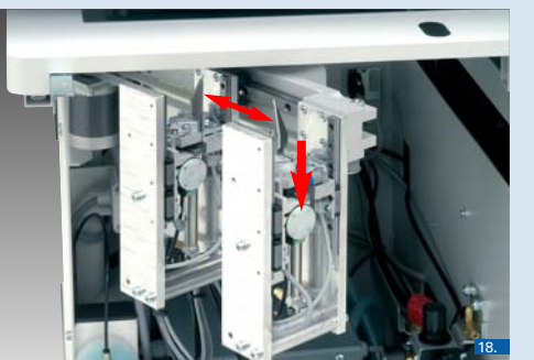
Vollautomatische Eckeneinschneidvorrichtung • Eckeneinschneidvorrichtung mit automatischer Pattschragenerkennung über zwei Fotozellen. Alle Funktionen des Nahtversatzes inklusive der Eckeneinschnitte werden automatisch ausgeführt. Bei einem programmierten Nahtversatz werden die Eckenmesser über Schrittmotore automatisch eingestellt. Der Einstellwinkel kann individuell mechanisch eingestellt werden.
