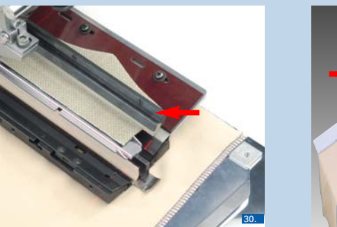
Klemme, rechts • Für Belegteile, wie z.B. Patten. Das Beispiel zeigt die Klemme rechts für Patten in der Hosenfertigung. Hinweis: Die Klemme ist bereits Bestandteil einiger Einrichtungen!
