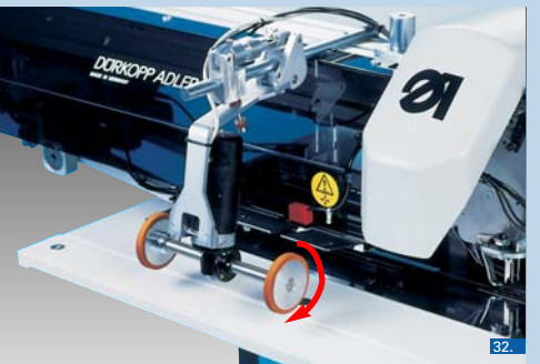
Ausrollvorrichtung, elektronisch regelbar • In Verbindung mit 0745 597694 (Bündelklemme) zu verwenden als Abstapelvorrichtung (z.B. für Hosenteile) oder zum Vorrollen von kurzen Teilen in Verbindung mit 0745 597554 (Überwurfstapler).
