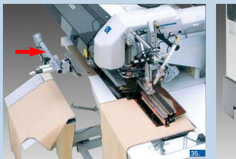
Universelle Abstapelvorrichtung mit Ablage (Zangenstapler) • Zum Ab stapeln der fertig genähten Teile (z.B. Hosenteile).
