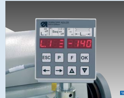
Bedienfeld mit 8-stelliger LED-Anzeige • Bedienfeld zum Programmieren von 9 unterschiedlichen Taschenprogrammen und 1 Sequenz; diese Sequenz beinhaltet max. 7 mögliche Speicherplätze.
