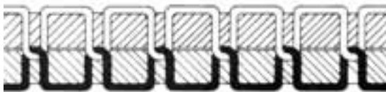
Abb. A: Korrekte Fadenverschlingung in der Mitte des Nähgutes
