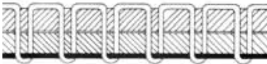
Fig. B: Tensión del hilo superior insuficiente ○ tensión del hilo inferior excesiva
