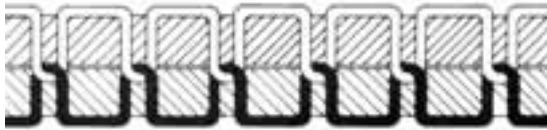
Fig. A: Enlazamiento correcto del hilo en el centro del material
