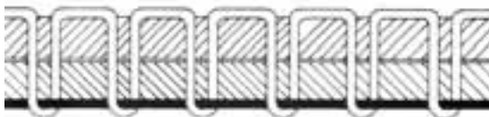
Fig. B: Tensão da linha da agulha muito fraca ou tensão da linha da lançadeira muito forte
