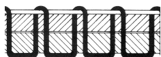
Illustration c: Tension du fil d'aiguille trop forte ou Tension du fil de canette trop faible
