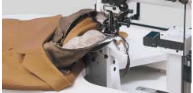
Arbeitsgänge der 697-24155: Schulterpolster in Armlöchern festnähen und beschneiden; Leibfutter in Armlöcher nähen und beschneiden
