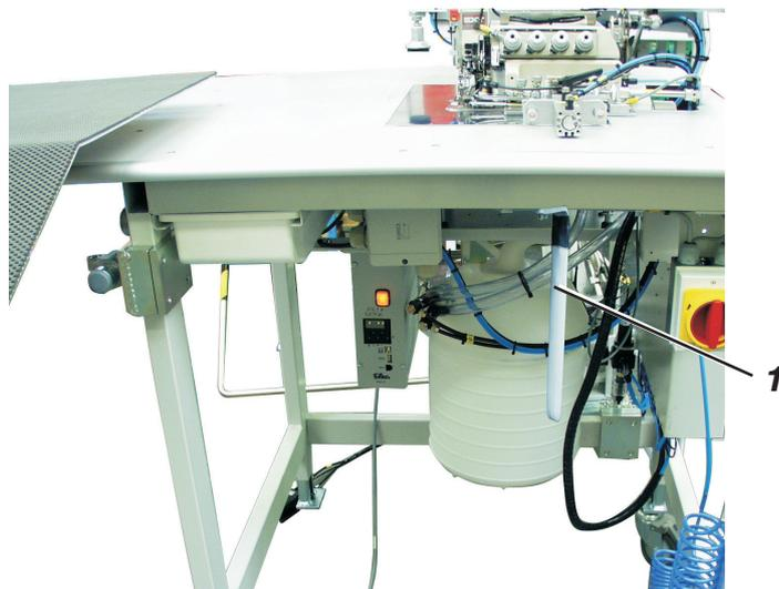
Über den Knieschalter 1 kann die Konturenführung während des Nähens ein- bzw. ausgefahren werden.
