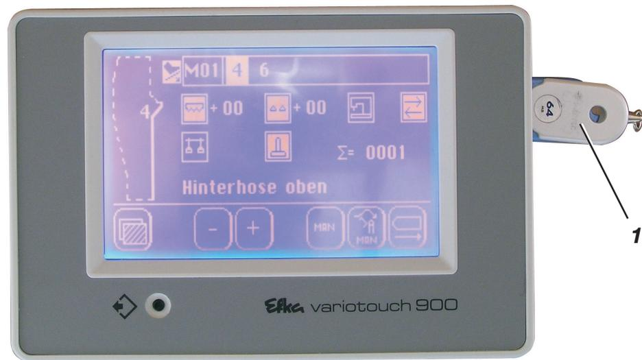
Der USB-Stick 1 dient zum Aufbewahren und zum Übertragen der Nähanlagensoftware.
