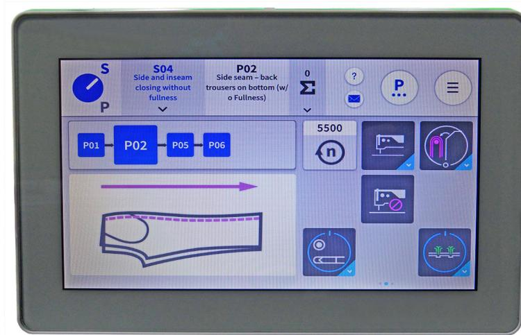
Alle Einstellungen in der Software der Maschine erfolgen über das Bedienfeld Commander Pro.
