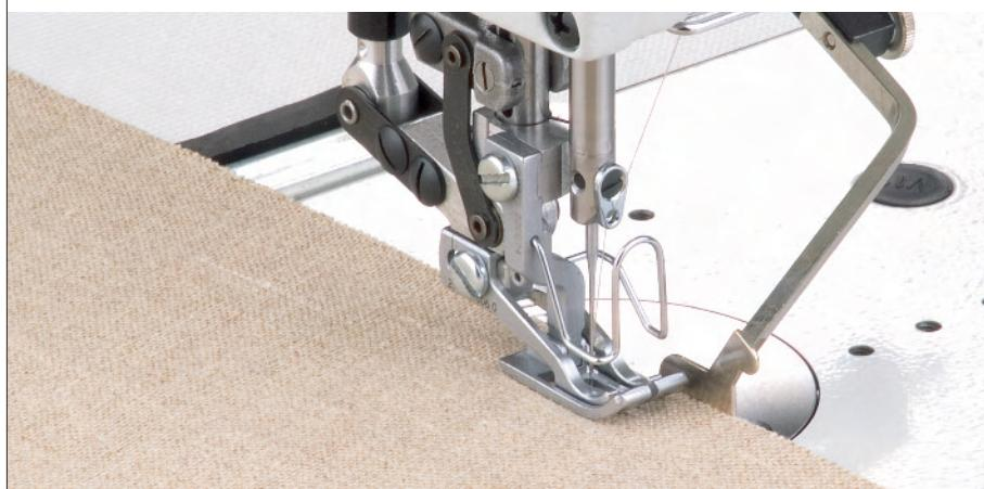
**275-740642-01 E104 (8 mm) – Bund aufnähen und gleichzeitiges beschneiden der Kante**
