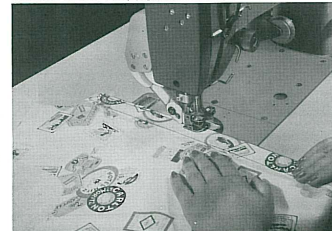
Adler 396 BF1-121 avec F 303, surpiquage d'une patte de devant d'un chemisier
