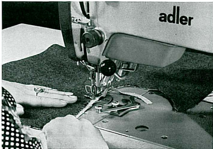
Adler 396 VF-162 Sakko-Armloch sichern und gleichzeitig überstehendes Plackmaterial verschneiden
