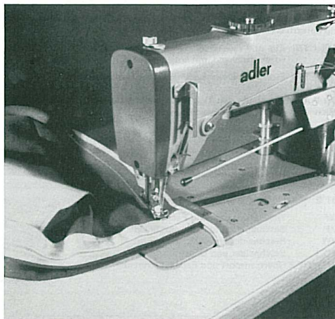
Gesäßnaht schließen auf Adler 371 OF1-222
