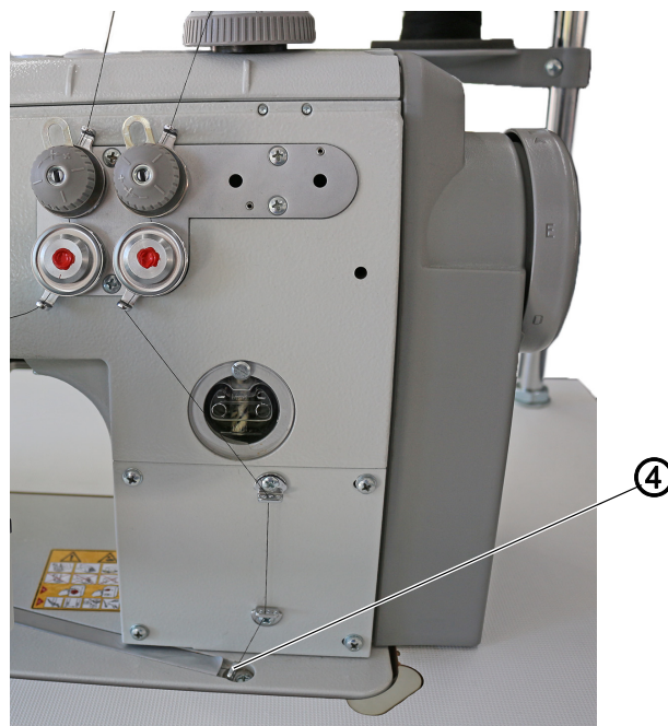
Abb. 77: Elektronische Greiferfaden-Spannung kalibrieren (2)
