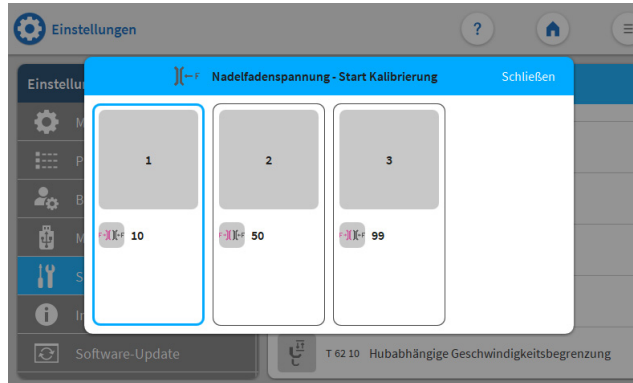
Abb. 74: Kalibrierung der Nadelfadenspannung (1)
