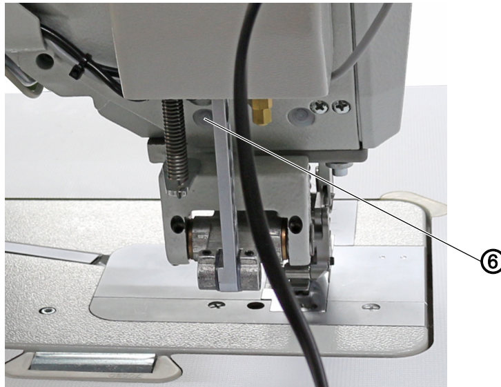
Abb. 31: Abstand zwischen Transportfuß-Stange und Stoffdrückerstange einstellen (3)
