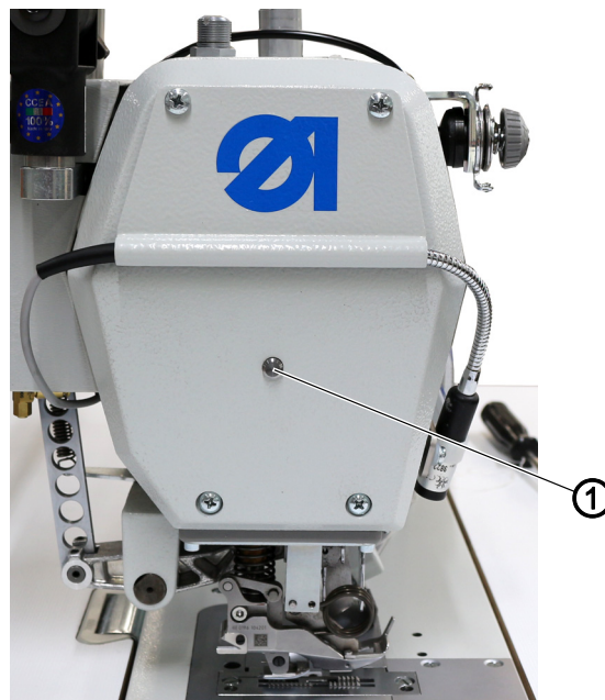
Abb. 57: Höhe der arretierten Nähfüße einstellen (1)
