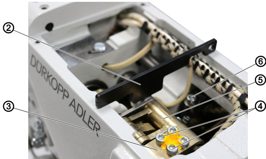
Abb. 50: Hub-Verstellbereich und Zeitpunkt der Hubbewegung des Transportfußes einstellen (2)
