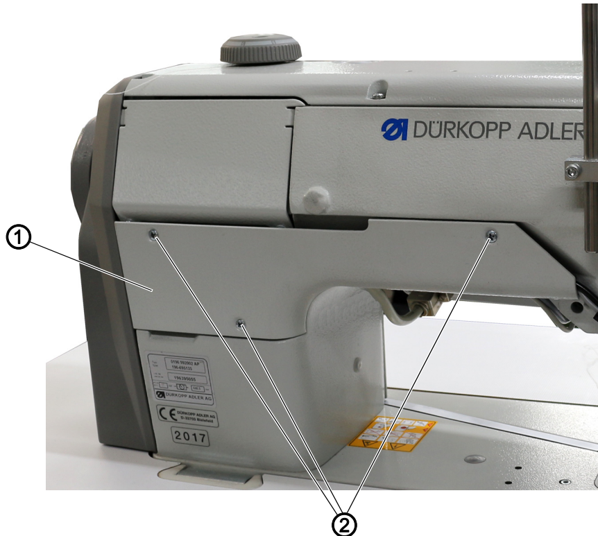
Abb. 9: Hintere Abdeckung abnehmen und aufsetzen
