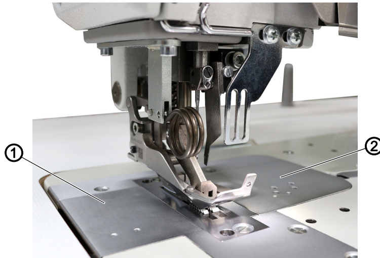
Abb. 16: Greiferabdeckungen öffnen und schließen (1)
