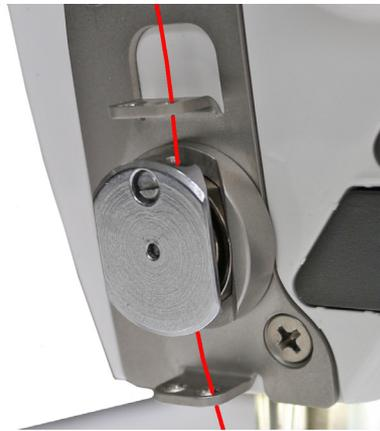
13. Faden von rechts in die Fadenklemme schieben, so dass der Faden im Haken der Klemme gehalten wird.
