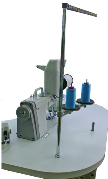
图 56: 组装线架 (最终状态)
