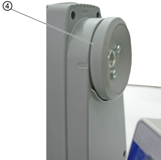
图 15: 设置压脚压力 (2)
