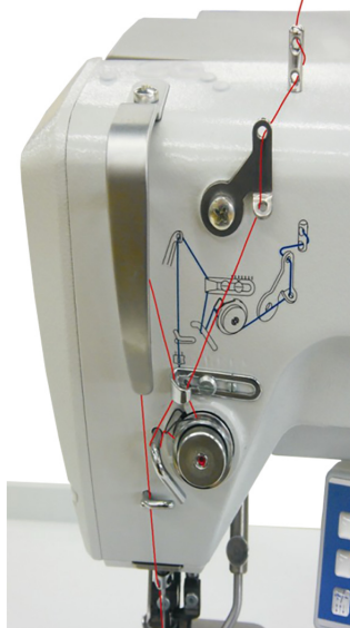
Abb. 5: Nadelfaden einfädeln bei hoher Dehnung
