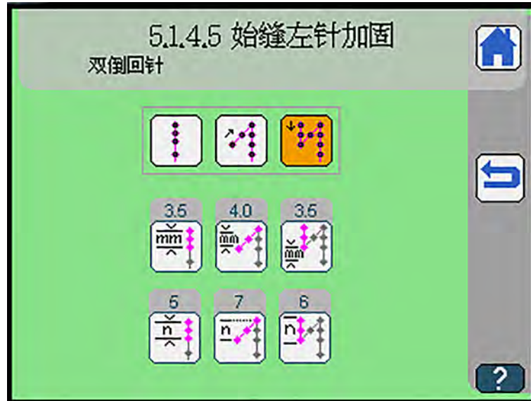
图 107: 设置始缝左针加固
