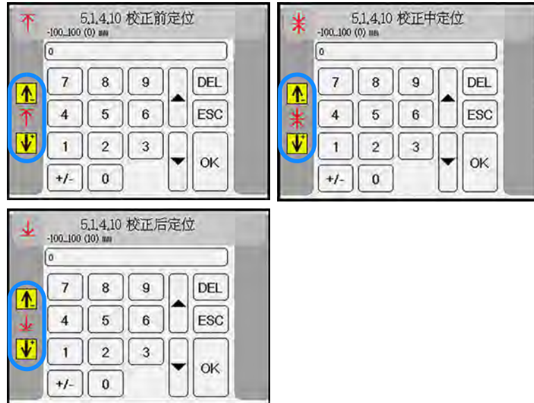
图 109: 设置定位点的修正值
