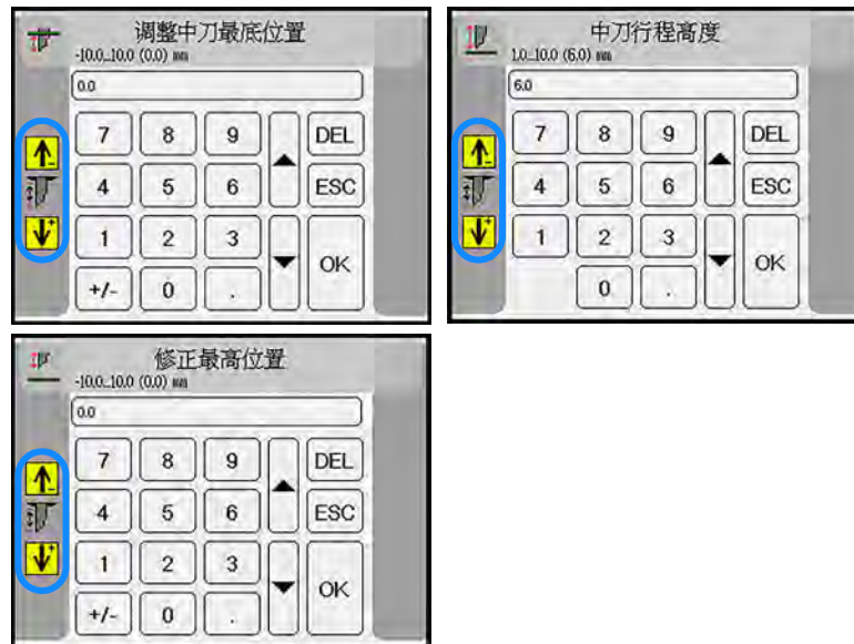
图 193: 调整中刀最高/最底位置、行程高度
