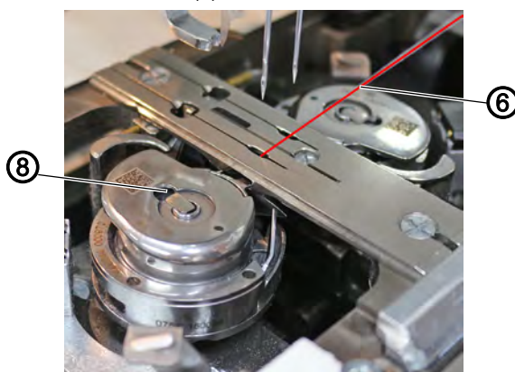
图 15: 设置梭芯线张力和梭芯制动力 (4)
