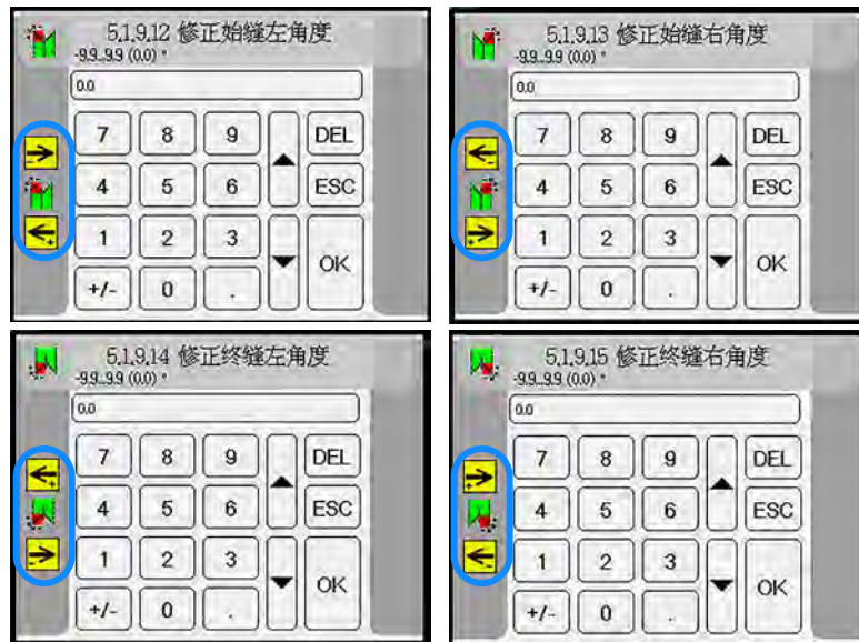
图 130: 校正始缝/终缝角刀角度
