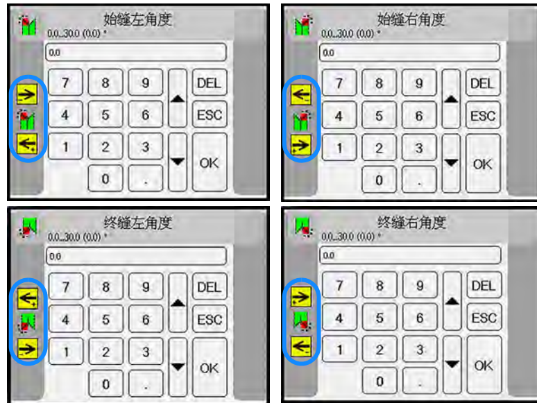
图 169: 设置始缝/终缝角刀角度
