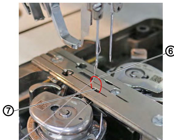
图 14: 设置梭芯线张力和梭芯制动力 (3)
