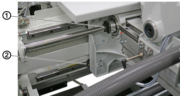
Abb. 143: Kugelbüchse der Drehmoment-Welle schmieren
