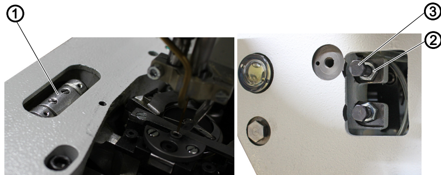
Abb. 4: Nullstellung des Stichstellers einstellen
