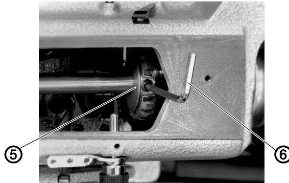
Abb. 44: Stellung der integrierten Justierscheibe zur Armwelle einstellen (2)
