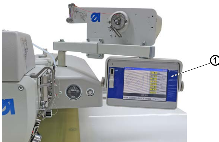
(1) - Nadzorna plošča OP7000
