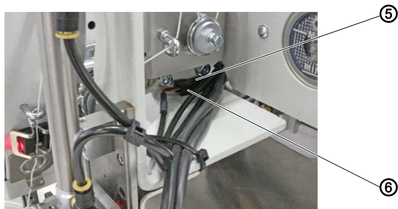
Abb. 10: Leitung zum Barcode-Scanner verlegen und anschließen (2)
