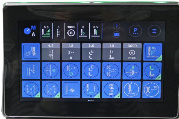
Všechna nastavení v softwaru stroje se provádějí prostřednictvím ovládacího panelu Commander Delta.
